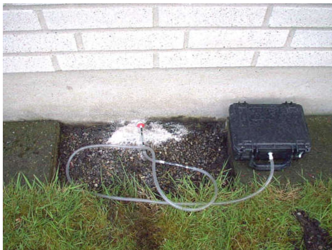
Udtagning af poreluftprøve under sokkel til udarbejdelse af risikovurdering i forhold til indeklima
